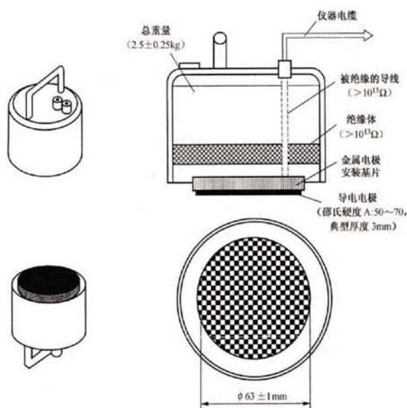
图 5 表面点对点电阻、对地电阻 (静电泄漏电阻)测试电极
