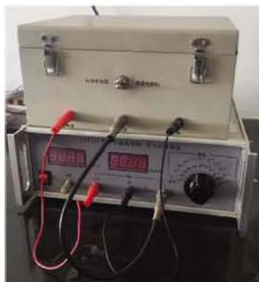
a 材料的表面和体积电阻测试
