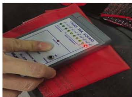
整体防静电材料 R_s \leq E12 \Omega
