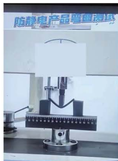
万能试验机: 弯曲、拉伸试验
