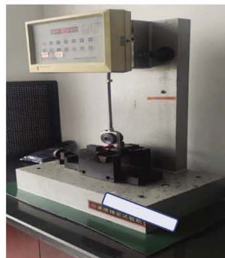
摆锤式简支梁冲击试验机: 冲击试验
