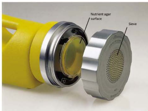
图 2.2 惯性撞击式空气采样器,前部筛子 分离后显示出内部的琼脂盘
