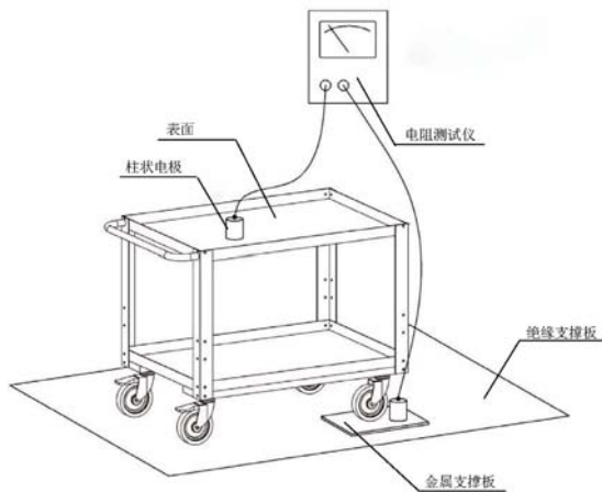
图 35 运转车台面对可接地点电阻测试示意图
