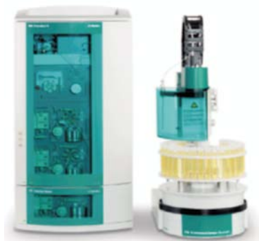
图 3 离子层析仪(IC)
