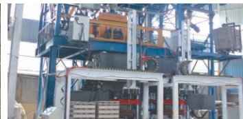
硫酸钙GRC基板生产流水线
