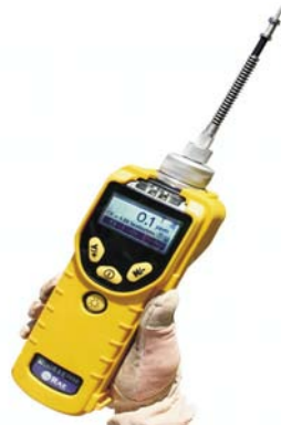
图 5 ppB-RAE 手持式 TVOC 测试仪及相关规格
