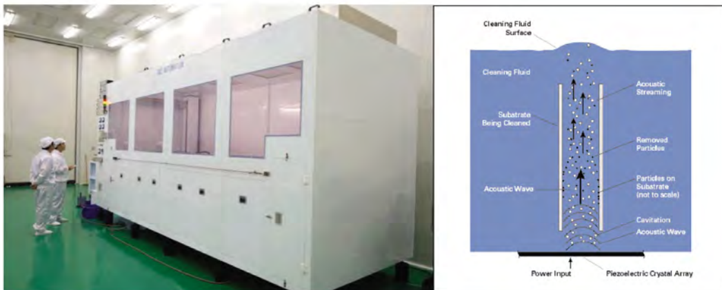
图 15 兆声、超声联合清洗机及其清洗原理示意图
