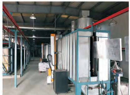
“华集”铝合金地板生产线，公司投入了 2000T-2500T 压铸机设备、全自动机器人取件、全自动给汤设备、全自动喷雾设备、机器人全自动抛顶针设备、全自动抛光机、全自动抛丸机、全自动环氧树脂粉末喷涂烘干、全自动喷胶贴面设备等先进设备。
