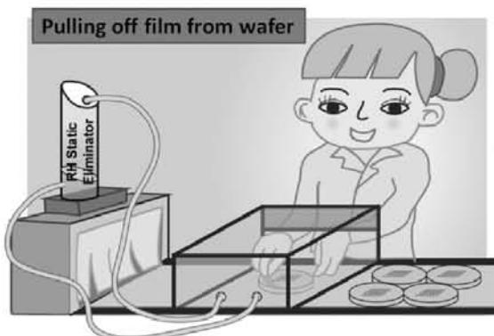
Fig. 6 (d) Pulling off film from wafer
