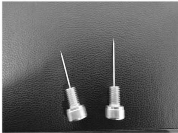
图 2 两种规格的放电针
