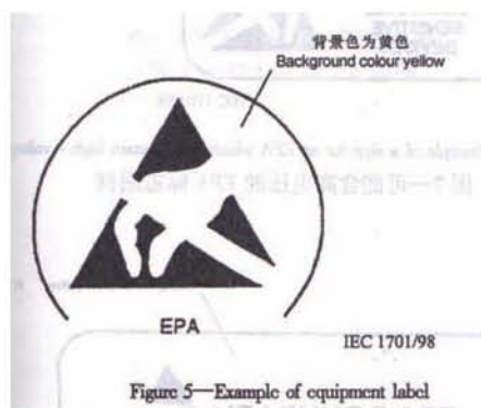
图1-2 EPA内电气设备标识
