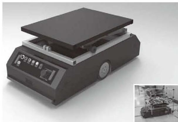
图 3 EPA 区域无人智能防静电 AGV 搬运系统
